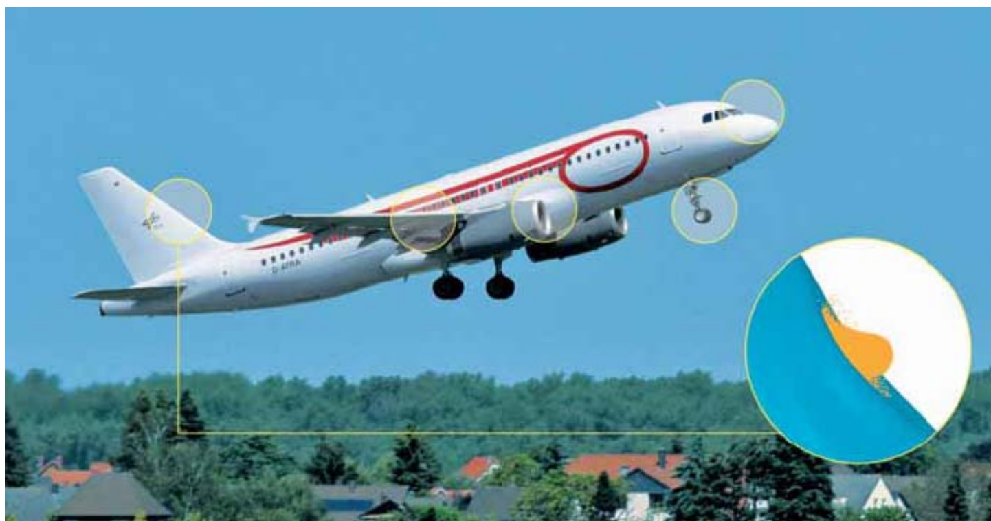
Abb. 1: Vogelschlaggefährdete Bereiche am Flugzeug sind die Flugzeugnase mit Cockpit und Radom, Fahrwerke, Triebwerke sowie Flügel- und Leitwerksvorderkanten. Vergrößerung (Kreis): Simulation eines Vogelschlags auf das Seitenleitwerk.
