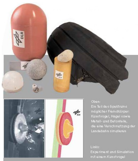
Abb. 2: Experiment und Simulation mit einem Kunstvogel Oben: Ein Teil des Spektrums möglicher Fremdkörper: Kunstvogel, Hagel sowie Metall- und Betonteile, die eine Verschmutzung der Landebahn simulieren Links: Experiment und Simulation mit einem Kunstvogel
