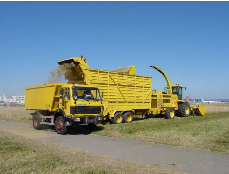
Entleerung des Schnittguts in Transportfahrzeuge mit Containeraufbauten
