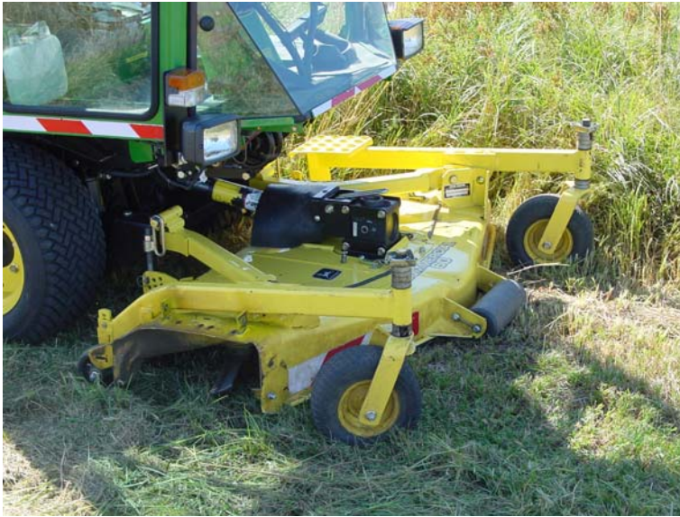
Rotationsmähergerät mit 1,53-m 3-Messer-Sichelmähwerke mit Seitenauswurf
