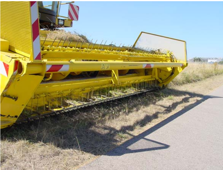
Erntevorsatz (Feldgrasschneidwerk) mit 420 cm Arbeitsbreite und Doppelmesserantrieb
