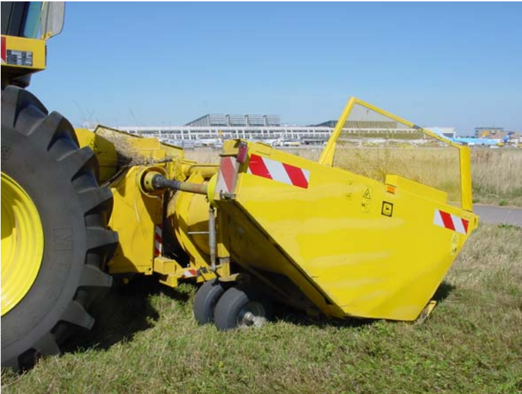
Die schwenkbaren Laufrollen am Erntevorsatz zur veränderlichen Verstellung der Schnitthöhe von 0 bis 35 cm
