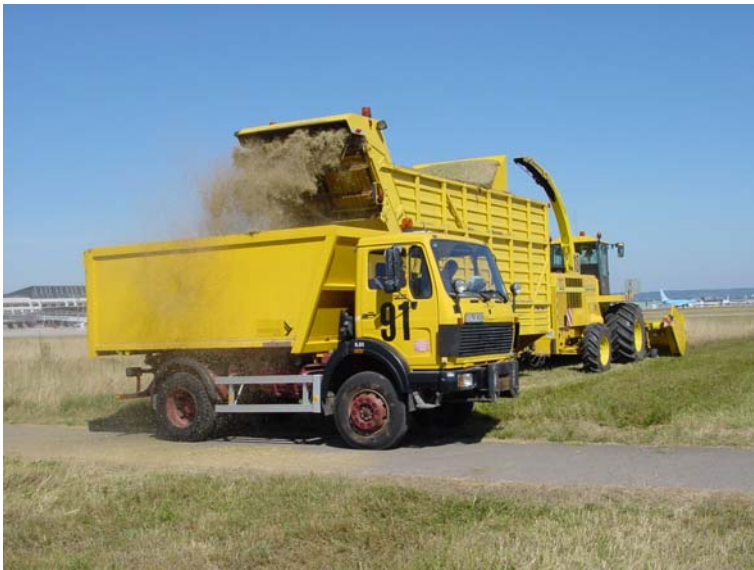
Schnittgutbunker bei der Entleerung
