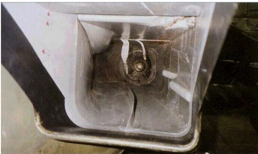
**Abb.: 1: Beschädigungen an einem Tornado infolge eines Vogelschlages.**
