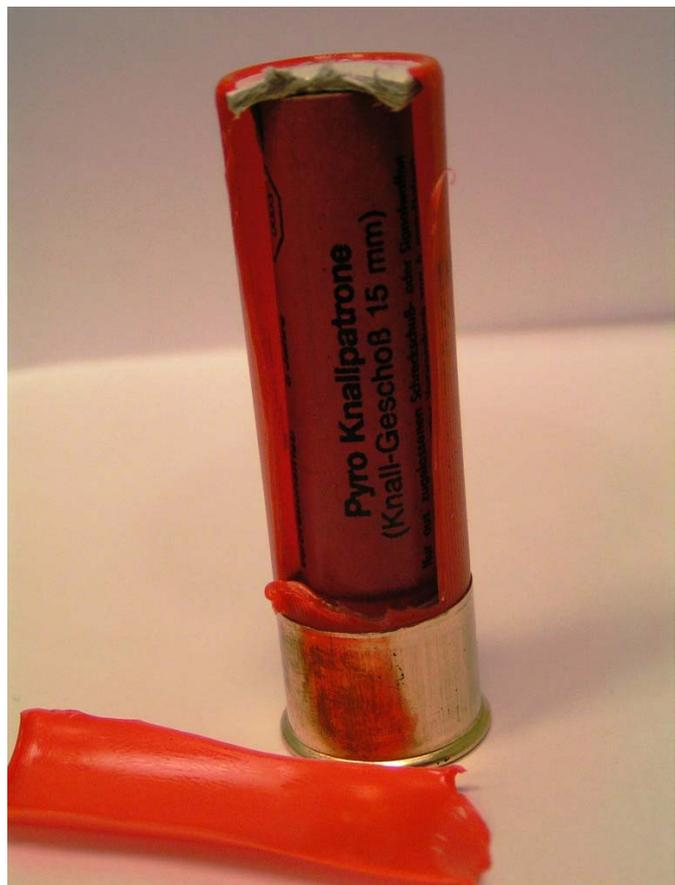
**Abb. 1 Aufbau einer Distanzpatrone**
